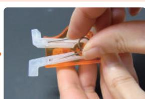
④交換用のスプリングをつまみ、白い部品の溝に先端方向へ滑らせるように入れます。
